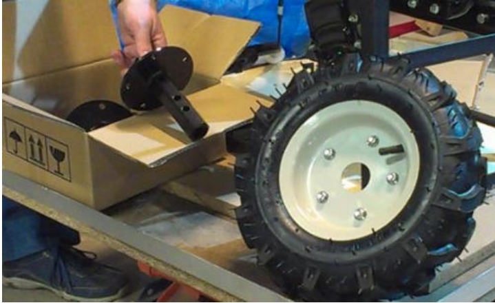
Remove bolts and nuts and assemble wheel support Verwijder bouten en moeren en monteer wielas Retirer les écrous et les boulons et assembler le support de roue
