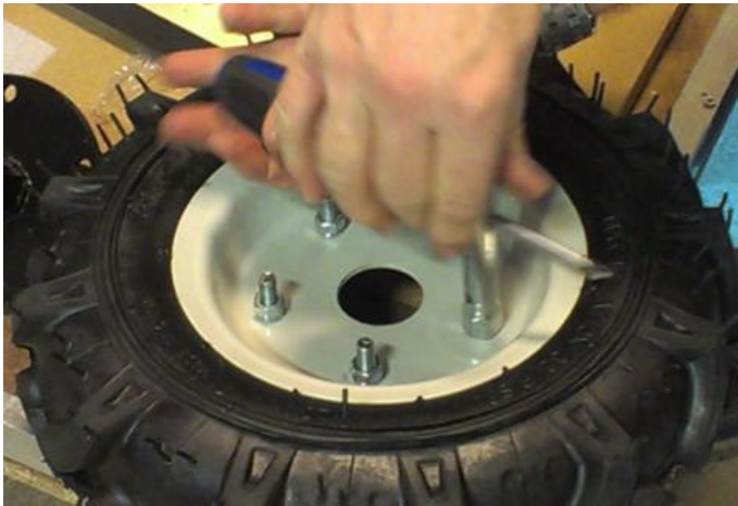
Remove bolts and nuts and assemble wheel support Verwijder bouten en moeren en monteer wielas Retirer les écrous et les boulons et assembler le support de roue
